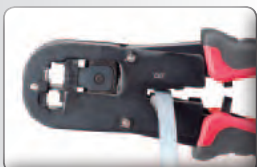
Corte de cables de red
