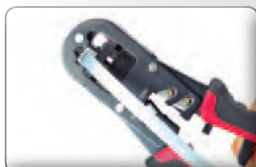
Prensado de las terminales
